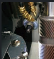
小砂轮磨削 (K型号磨削头)
