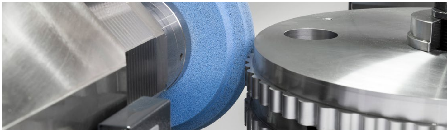
在霍夫勒 VIPER 500 K 圆柱齿轮磨齿机上展示的摆线齿轮加工
