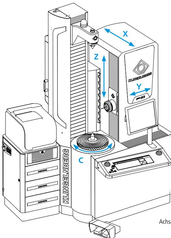
Achsanordnung eines Präzisionsmesszentrums
